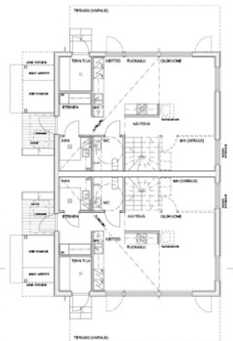
TALO D - PARITALO 2 x 124 km 2 / 103 huon 2 1 KR, POHJAPIIRUSTUS 1:100 2x 34 H+OH+BUKKEITTU+ET+90H+S+P+H(WC)+H+TKN.TLA
