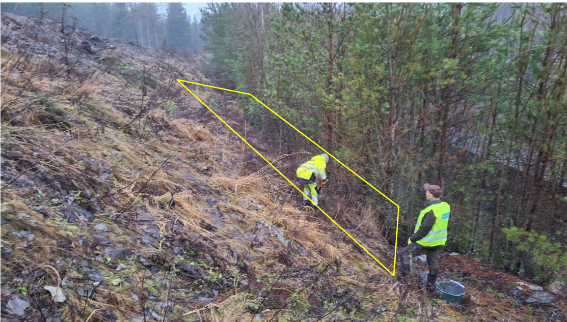
Kuva 02. Kokoomanäyte KOK2 kerättiin pienoiskivääriradan ampumapenkan pintamaasta puurajasta, sekä noin 1 m sen alapuolelta. Alue on rajattu kuvassa keltaisella.
