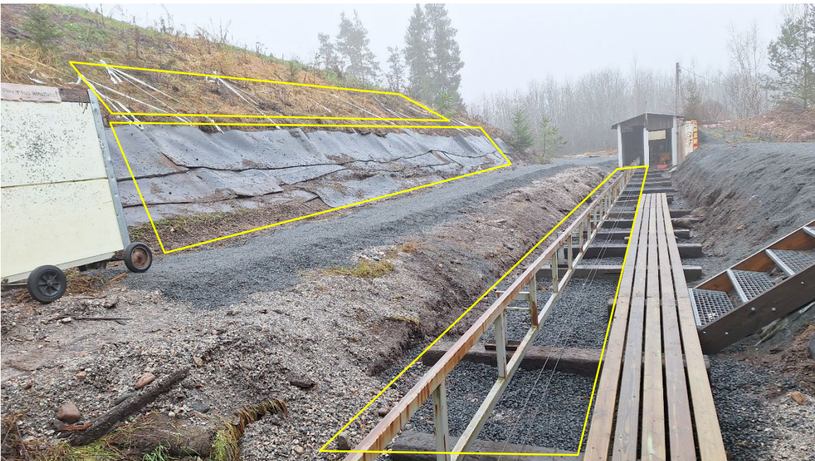
Kuva 06. Kokoomanäyte KOK7 kerättiin hirviradan maalialueella olevan kuljetuskiskon alapuolisesta maaperästä kuvan oikealle puolelle keltaisella rajatulta alueelta. Kokoomanäyte KOK8 kerättiin ampumapenkasta kumimattojen alta ja kokoomanäyte KOK9 kumimattojen yläpuolelta. Alueet on rajattu kuvan vasemmalle puolelle keltaisella (KOK8 alhaalla, KOK9 ylhäällä).
