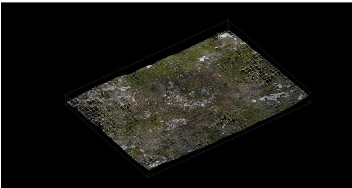
Kuva 51: Värjätty pistepilvimalli Järviluoto 2E:n kivirakenteesta, mukana 0,5 x 0,5 maastomalliverkko. Perspektiivi lounaasta.
